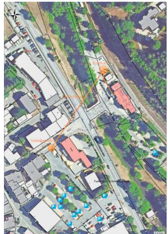
Trassenverlauf der Spülbohrung unter der Selbitz hindurch
